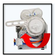
Setzen Sie den Deckel wieder auf das Gehäuse und schrauben Sie es im Uhrzeigersinn mit Hilfe des Membrangehäuse Schlüssels wieder zu.
