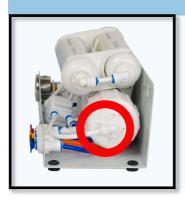
Schieben Sie den zuvor herausgezogenen Schlauch wieder in den Anschluss am Membrandeckel hinein. Achten Sie darauf, dass der Schlauch bis zum Anschlag geschoben wird.
