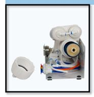
Setzen Sie die Membran mit den 2 kleinen schwarzen Gummidichtungen zuerst in das Membrangehäuse ein und schieben Sie diese bis zum Anschlag durch.
